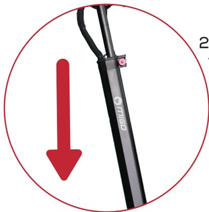
2. Liberar el gancho de Nivelación del Mástil de dirección y deslizar hacia abajo el tubo.
