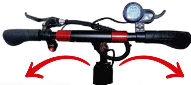
2. Liberar el gancho de Nivelación del Mástil de dirección y deslizar hacia abajo el tubo.
